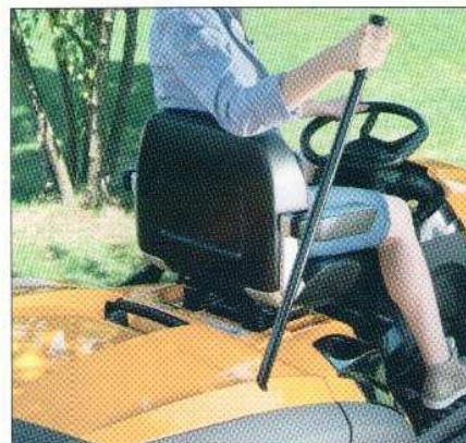
El recogedor incorpora palanca para su vaciado desde el asiento.
